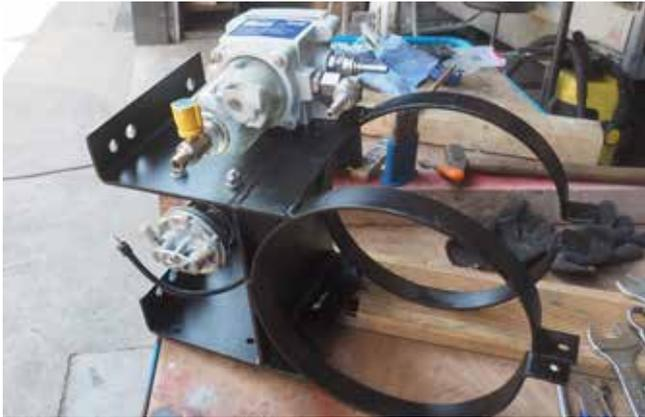
Die aufwendig gebaute Konsole nimmt Separ-Filter, Hardi-Pumpe, den Catch-Tank, die Tankumschaltmechanik und die Kipphydraulikpumpe auf.
