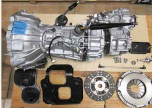
Für alle HZJ ab 2000: Umrüstkit auf das viel robustere HDJ -Getriebe mit Verteilergetriebe inkl. aller erforderlichen Anbauteile und einer neuen verstärkten Kupplung € 8.450,00
