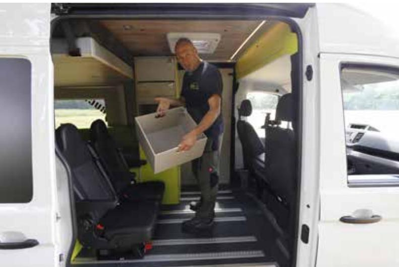
Die Schubkästen gleiten auf Holzschienen. Der elektrische Dachlüfter saugt frische Luft rein und verbrauchte drückt er raus.
