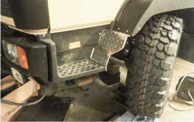
Nach dem Kürzen des Kotflügels und der Trittstufe werden beide mit einer gekanteten Riffelblechplatte verbunden.
