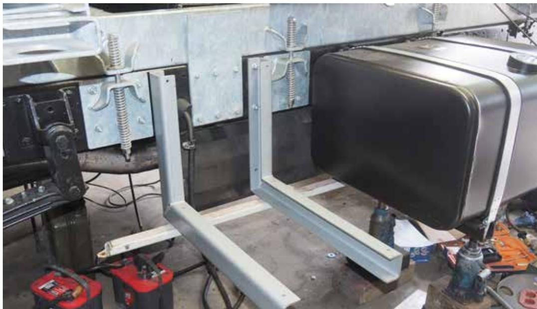
Auf der Fahrerseite finden dank der verlegten Druckluftanlage nun eine Staubox und ein 200 Liter Alutank Platz.
