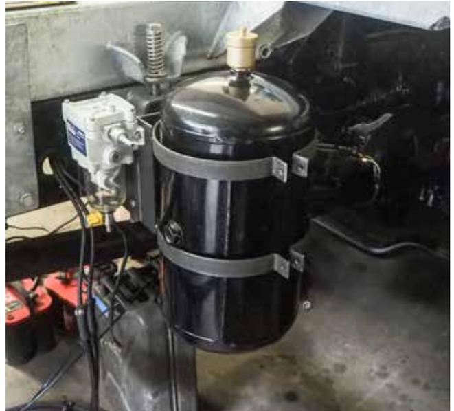
Catch-Tank mit Separfilter. Die Hardi-Pumpe sitzt im Inneren der Konsole.
