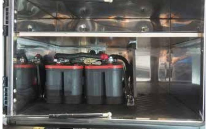
In der Staubox sind u.a. auch die Starterbatterien verbaut. Sie ist abschließbar und damit sind auch die Batterien gut gesichert.
