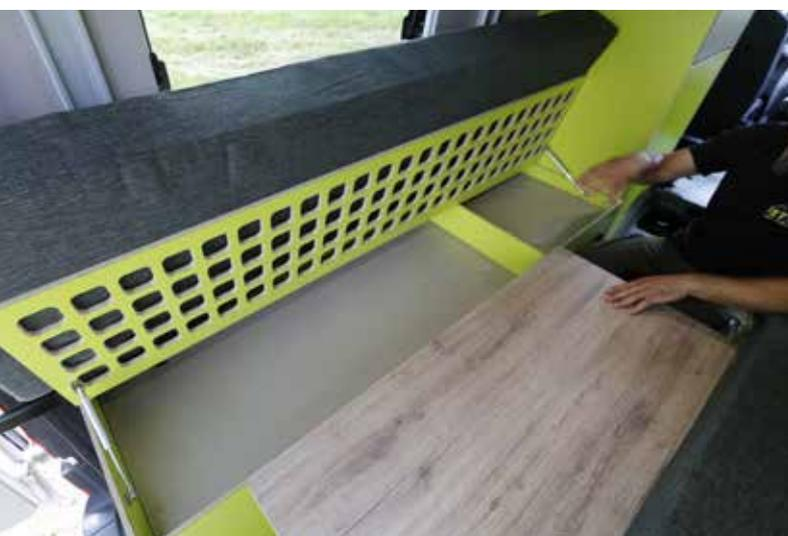
Gasdruckdämpfer halten die Klappe auf, auch mit Polster drauf funktioniert das. Fräsungen im Deckel vermindern das Gewicht.
